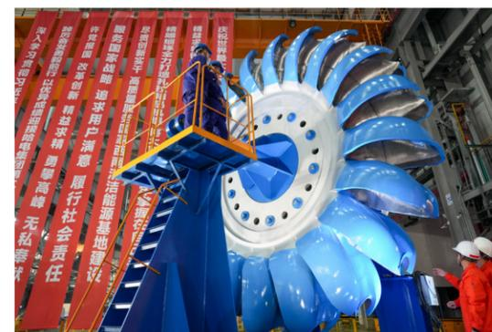
12 月 30 日，世界最大单机容量、最大尺寸冲击式水轮机转轮焊接制造成功
