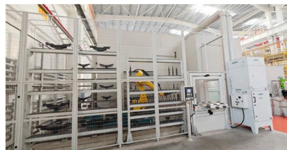
高压电机数字化机座加工单元，使高压电机机座由传统多机联合加工模式转变为单机复合化、自动化、数字化的新加工模式。实现高压电机机座加工产能提升 33%，加工效率提升 28%，在同等产量下，人员减少 25%
