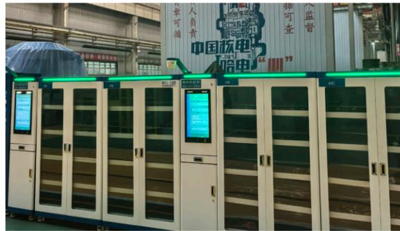
动装公司引入智能工具柜及吊索具二维码蓝牙智能链条锁系统,实现自助式存储、批量借用/归还、逾期提醒等功能,通过物联网实现系统信息的智能化可追溯,消除吊索具日常使用、管理过程中的安全隐患,降低起重作业风险
