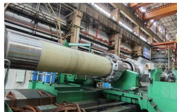
8月14日，国内最长（18.41米）的抽蓄机组水泵水轮机、发电电动机联轴——浙江天台抽水蓄能电站首台机组水发联轴找摆，顺利通过验收
