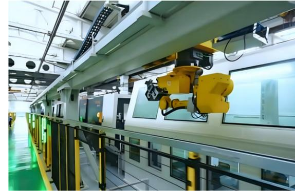
中小叶片全序全流程数字化产线，通过智能化改造，实现了叶片打标、加工、检测、转运等工序 24 小时自动化运行，较单机制造模式，机床综合利用率提高 8%，减少了在制品的频繁转运和设备等待时间，年叶片产出提升超过 20%，叶片加工的稳定性提升至 99% 以上，人均产出率增长超过 300%，实现全流程质量追溯，物料流转周期大幅缩短，形成 4 项发明专利
