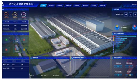
重装公司实施燃气控平台建设,对公司厂房加装可燃、有毒气体探测报警器,建立一体化安全智能化管控平台,实时显示厂区各监测点的位置信息和气体浓度数据,及时通知责任人处理报警信息
