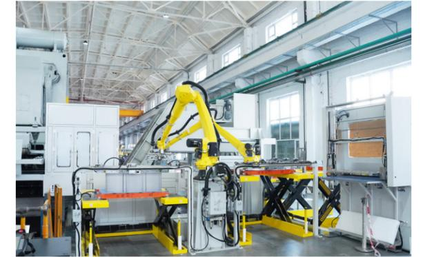
冲剪数字化车间，建成行业领先的水火电定子冲片数字化智能制造工厂，实现冲片原材料入库到成品包装的全自动生产运输。提高生产效率 20%，提升整体产能 30%，用工成本降低 30%
